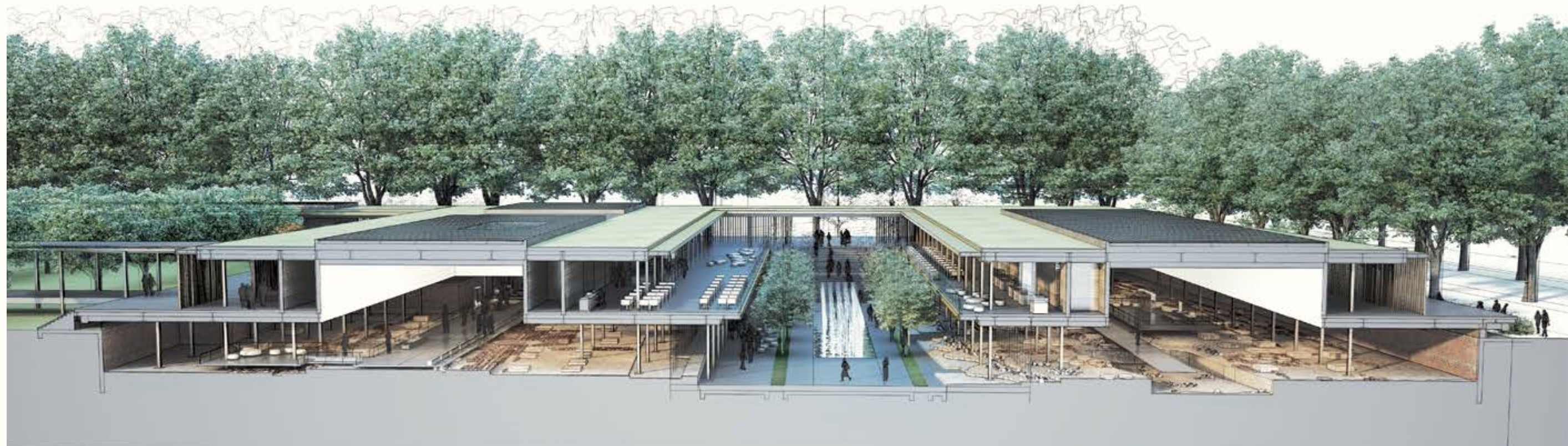
Coupe perspective sur le musée illustrant la légèreté du bâtiment du musée sur le site archéologique Sectional perspective showing the lightness of the structure over the archaeological site
